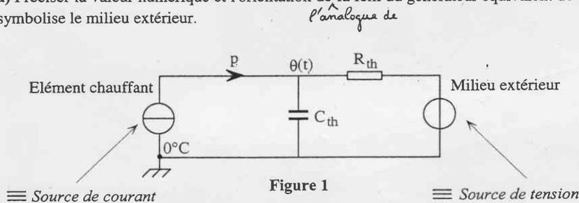
2.1.b) Quelle loi de Kirchhoff appliquée au réseau électrique, traduit-elle le bilan thermique du "réseau thermique" ?
