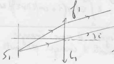
$S_1$  étant dans le plan focal objet de  $L_1$ , tout rayon issu de  $S_1$  ressort avec l'angle  $i$ . Son cheminement après réflexion sur  $\Pi_1$  et  $\Pi_2$  donnera deux rayons parallèles ayant la même inclinaison  $i$  par rapport à l'axe  $C_1 F_2$ . Ils convergent donc toujours en  $\Pi$ .
