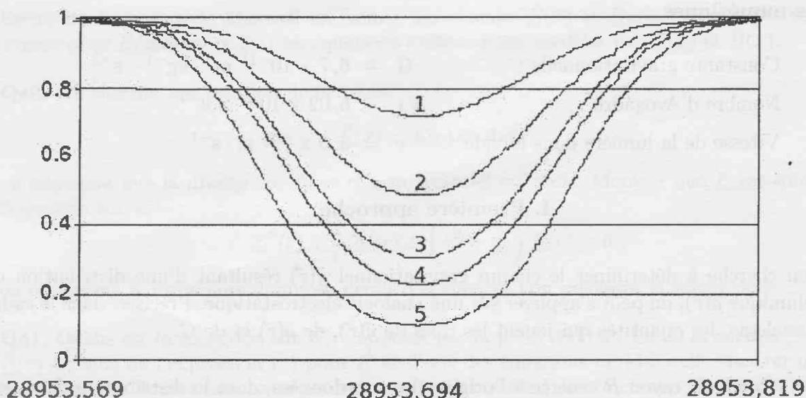
FIG. 2 – Profil d'absorption  $T$  en fonction de la fréquence de l'onde incidente en GHz.
